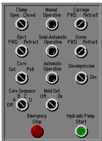
Hình 5.22 - Bảng điều khiển điện hình trên máy ép phun.
